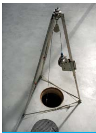
Fot. 42 Trójnóg ratowniczy nad studzienką
